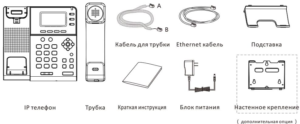
**Внимание:** Установка кабеля трубки разъем А укороченный, вставляется в трубку, удлиненный В в IP телефон.
