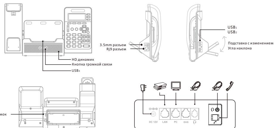
Note: USB1 мощность 0.5A для зарядки устройств.
